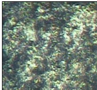
Figura 10. Material de blindaje distribuido de manera uniforme en la superficie, imagen microscópica a 200X
