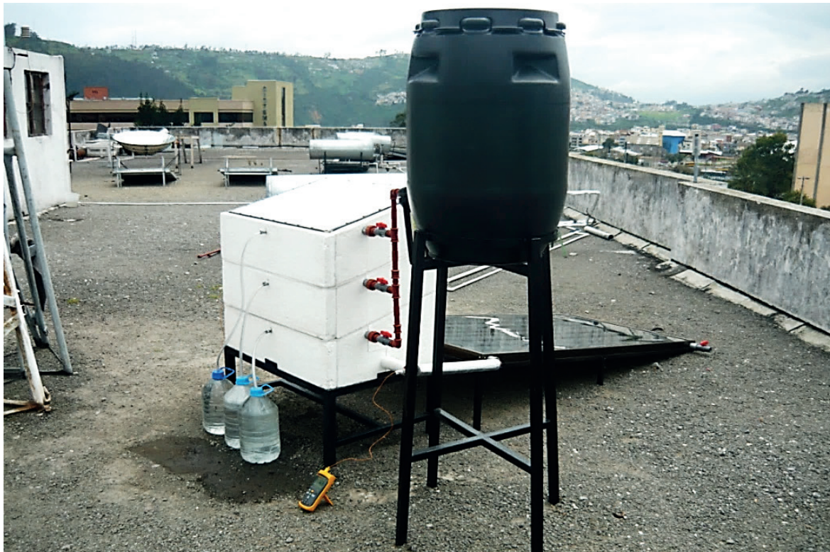
Figura 5. Desalinizador solar en funcionamiento
