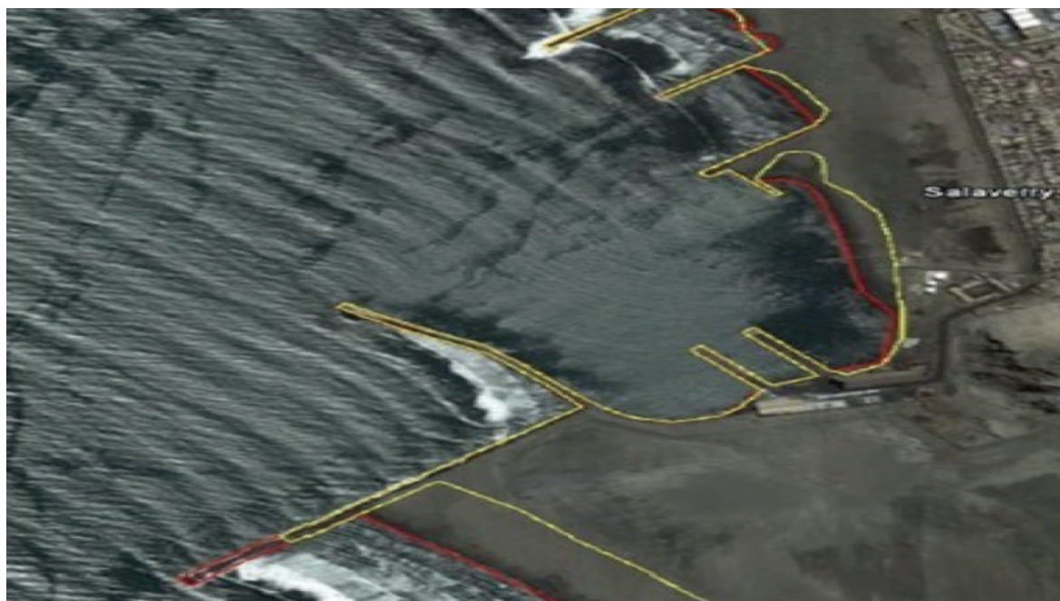
Figura 7. Imagen satelital del cambio de la costa en el lado sur de Salaverry Puerto
