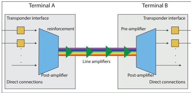
Fig. 4. Multiplexación y demultiplexación en DWDM, basado en [18].
